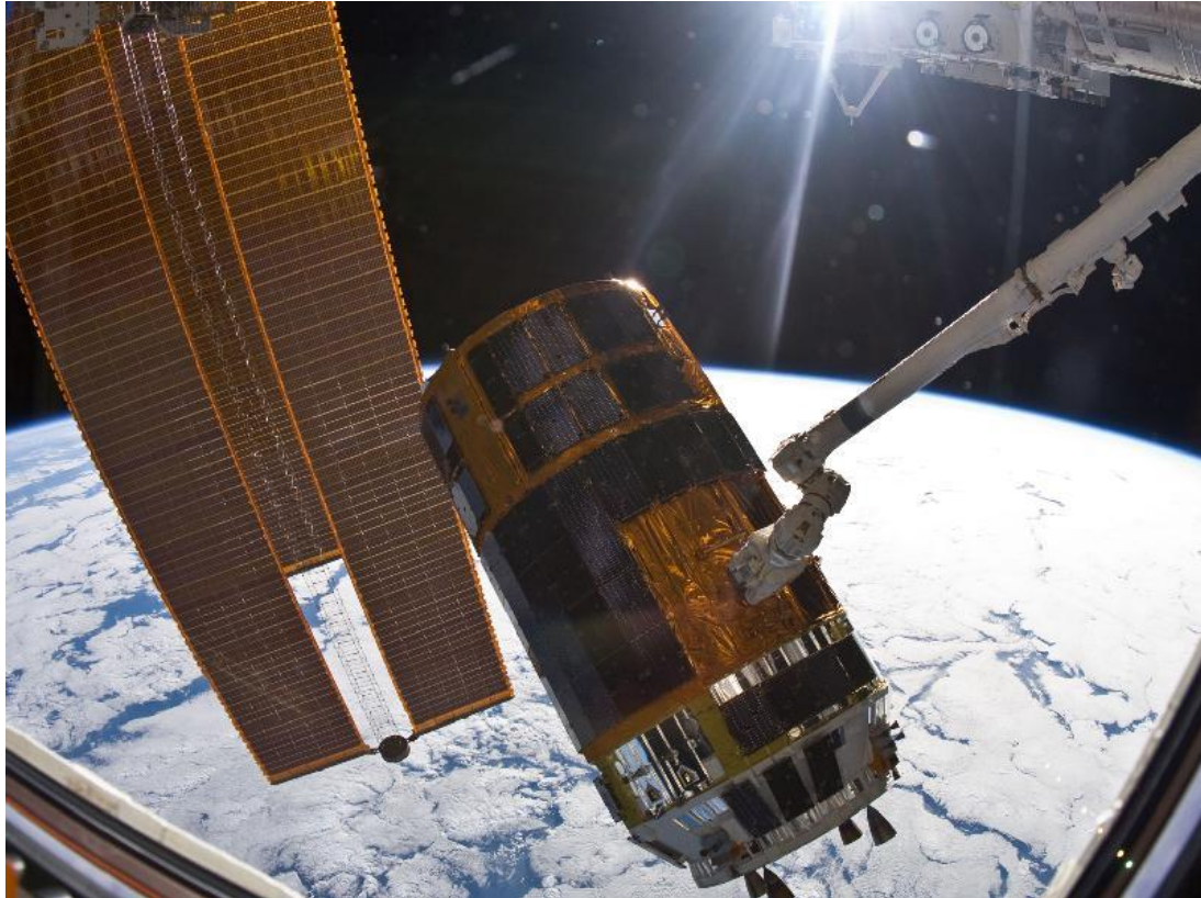
A már az ISS-nél levő japán Kounotori-2 (HTV-2) teherűrhajót február 18-án a robotkarral ideiglenesen áthelyezték a Harmony modul Földdel ellentétes oldalára, hogy helyet csináljanak a hamarosan érkező Discovery-nek. (Kép: NASA)
