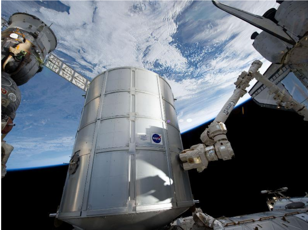
A március 1-jén készült kép közepén a kanadai gyártású Canadarm-2 robotkar az olasz építésű Leonardo többcélú tárolómodult tartja, amely most véglegesen az ISS-hez csatlakoztatva marad, a Unity egység Föld felé néző oldalán. A fotón jobbra a Discovery űrrepülőgép, balra egy orosz Szojuz űrhajó részlete is látszik. (Kép: NASA)
